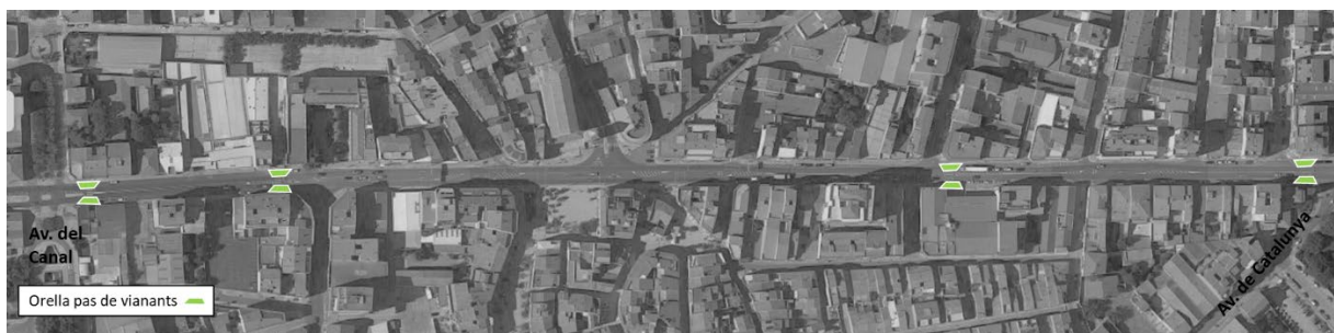
Proposta instal·lació relles als passos de vianants de la N-II
